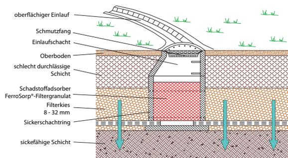
Einsatz von FerroSorp® RW bei der Schachtversickerung
